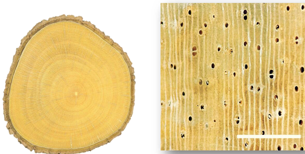
Figura 9 – Seções transversais de Handroanthus serratifolius : a) tora e b) madeira (escala=1mm).
