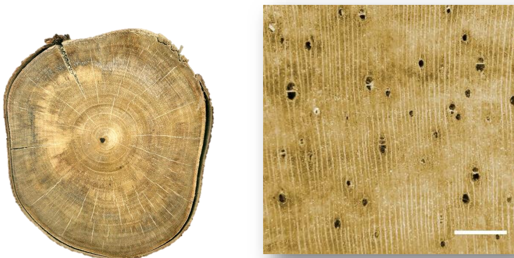
Figura 10 – Seções transversais de Dalbergia nigra : a) tora e b) madeira (escala=1mm).
