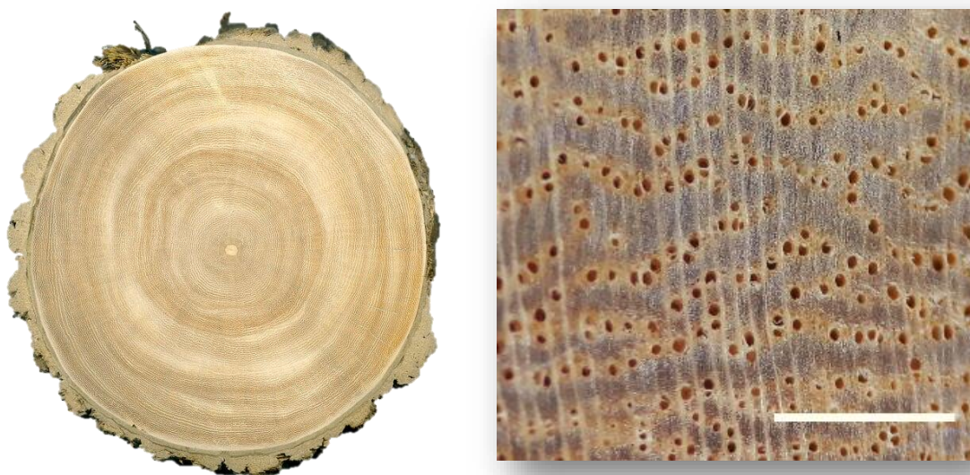
Figura 3 – Seções transversais de Zeyheria tuberculosa : a) tora e b) madeira (escala=1mm).
