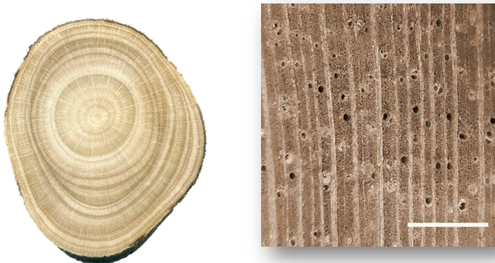
Figura 5 – Seções transversais de Cordia trichotoma : a) tora e b) madeira (escala=1mm).
