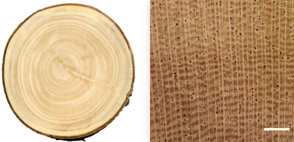
Figura 4 – Seções transversais de Cariniana legalis : a) tora e b) madeira (escala=1mm).
