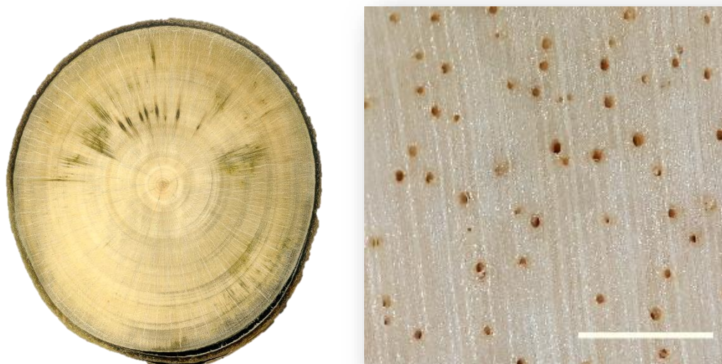
Figura 6 – Seções transversais de Astronium graveolens : a) tora e b) madeira (escala=1mm).
