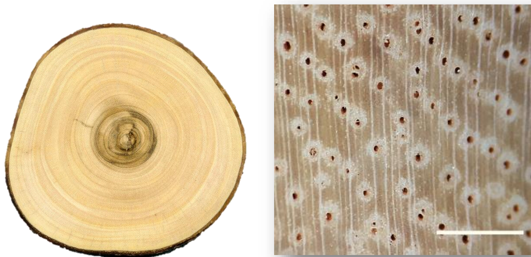
Figura 8 – Seções transversais de Parapiptadenia pterosperma : a) tora e b) madeira (escala=1mm).
