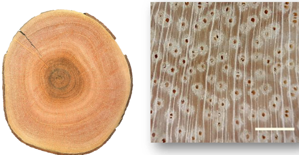
Figura 7 – Seções transversais de Anadenanthera peregrina : a) tora e b) madeira (escala=1mm).
