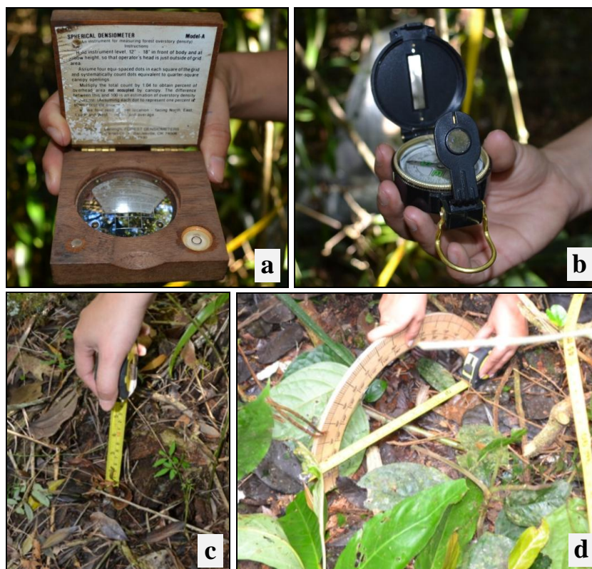
Figura 28: Equipamentos utilizados, para auxiliar nas coletas de dados da estrutura da vegetação: a. densiomêtro esférico côncavo; b. bússola; c. trena; d. transferidor de 180 0 e trena.
