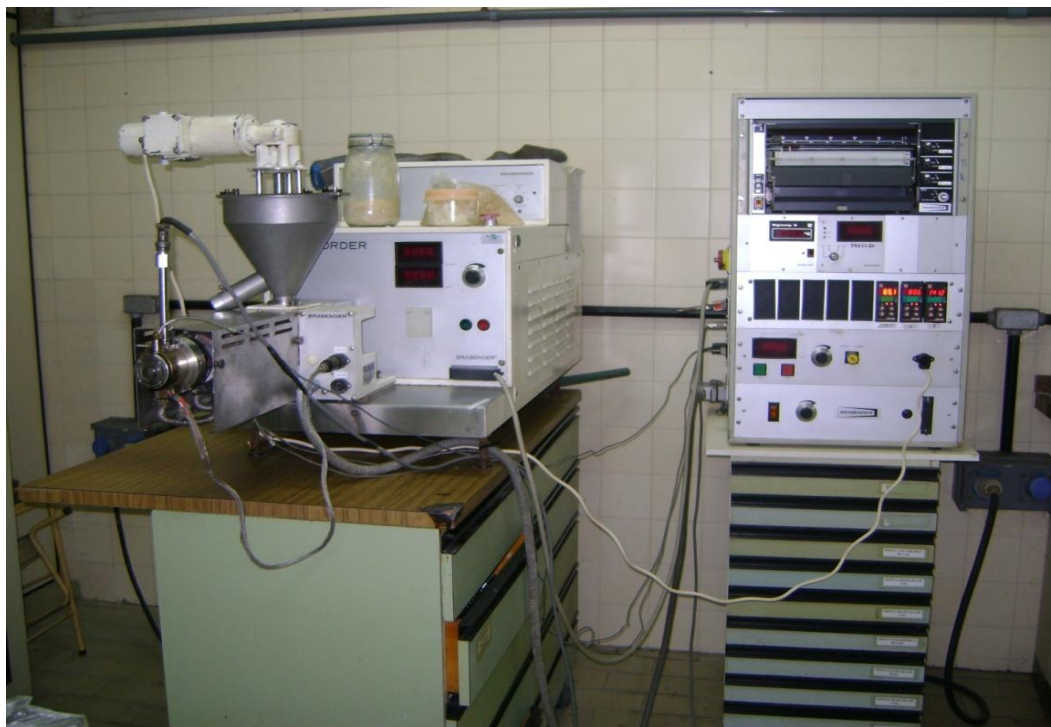
Figura 3. Extrusor monorosca, marca Brabender, modelo 20 DN (Duisburg, Alemanha) utilizado para a produção dos extrudados expandidos de arroz e concentrado proteico de soro de leite bovino (Créditos: Carla da Silva Teba).
