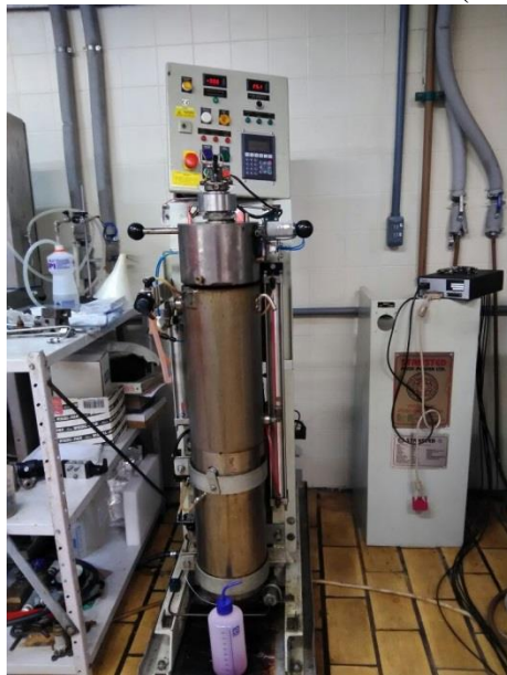
Figura 3: Equipamento de alta pressão hidrostática, Embrapa Agroindústria de Alimentos.
