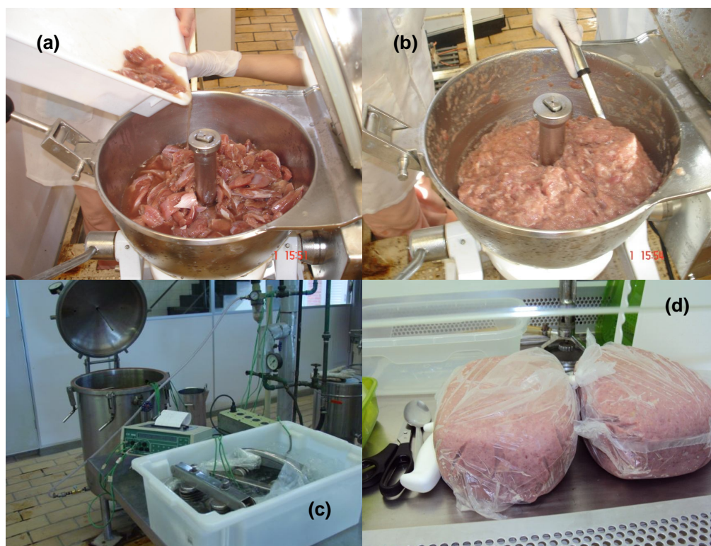
Figura 2. (a) e (b) “Cutter” com a carne de peru em pedaços e salmoura (c) Autoclave para cozimento e formas de aço inox em banho de gelo e (d) presunto de peru – Processamento na planta piloto II. (Fonte: autora).
