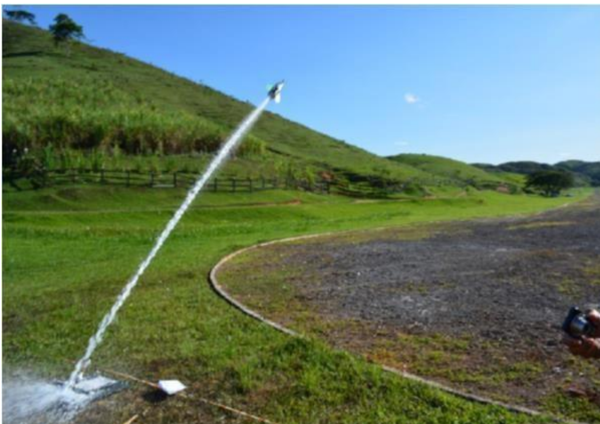
Figura 14 – Foto ilustrativa de um foguete de garrafa PET, recém-saído de sua base de lançamento usando como combustível vinagre e bicarbonato de sódio.
