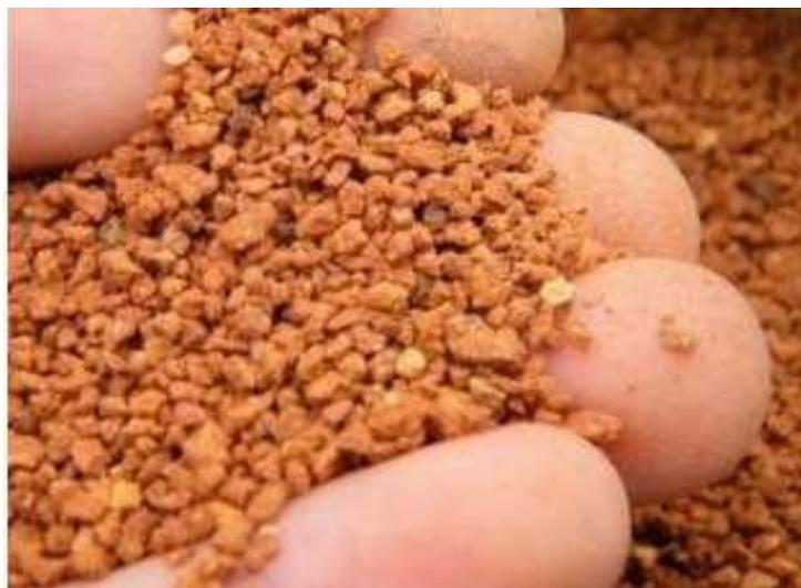
**Figura 22** – Exemplo de material para substrato: caqueira cerâmica.
