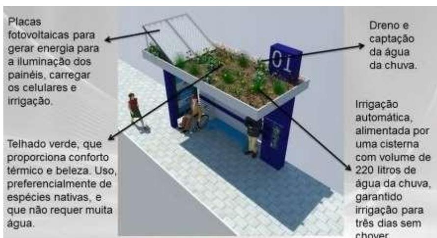
**Figura 12** – Integração de telhado verde com painel solar e aproveitamento de águas pluviais, em ponto de ônibus em Florianópolis - SC, Brasil.
