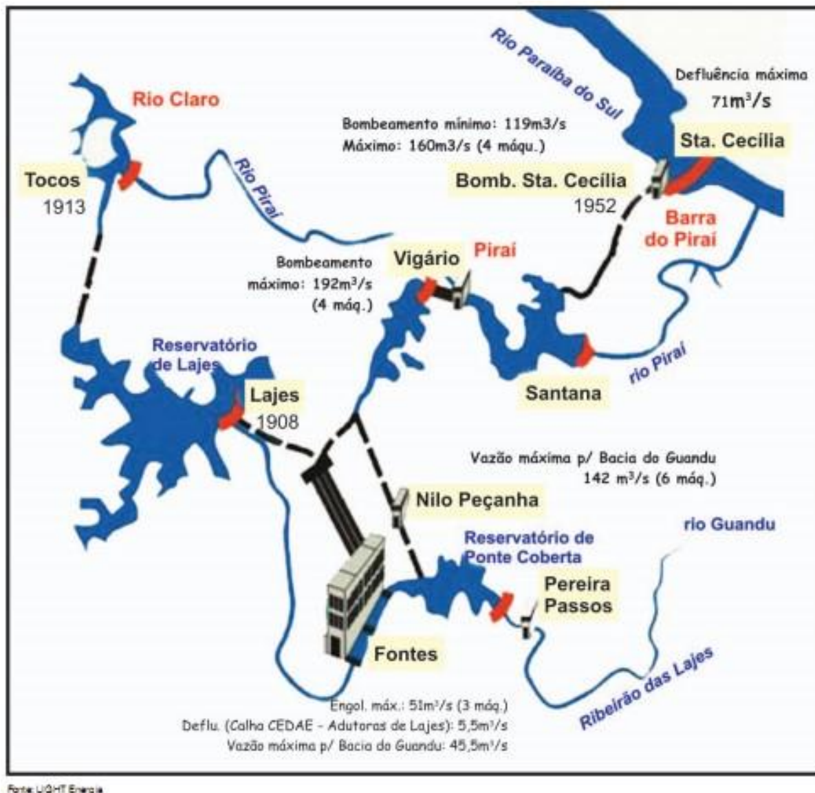
Figura 11 – Esquema representativo do sistema de transposição das águas da bacia do rio Paraíba do Sul para a bacia do Rio Guandu
