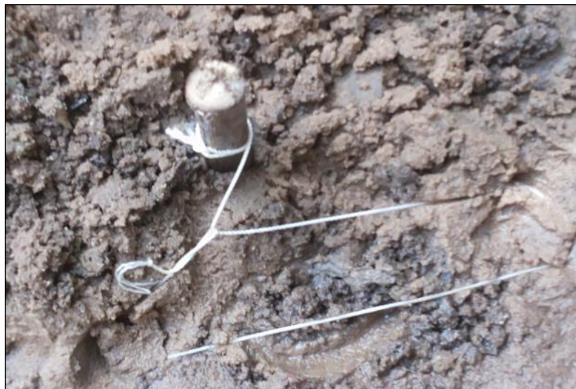
Figura 7: Técnica do Laço. Fonte: PASSOS, 2015.
