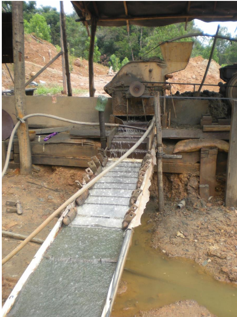
Figura 10 Cominuição de fragmentos de rocha de ouro primário em moinho de martelos passando pela “cobra fumando” em garimpo no estado do Amapá. Fonte: A autora.
