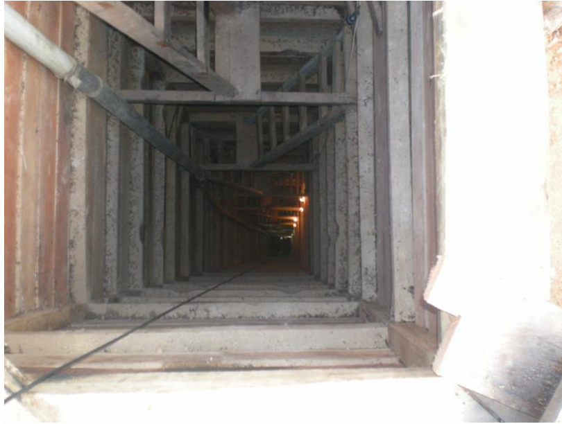
Figura 9 Shaft de ouro primário com profundidade de 42m no estado de Amapá. Fonte: A autora
