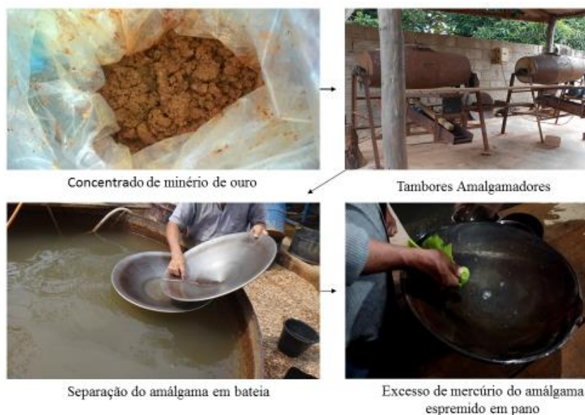
Figura 11 Etapas do processo de amalgamação de minério de ouro em tambor amalgamador, seguido de separação em bateia e retirada do excesso de mercúrio em pano. Fonte: A autora.
