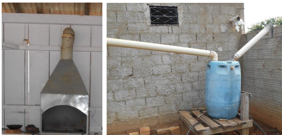
Figura 21 Capela com sistema de exaustão e recipiente para contenção de vapores de mercúrio
