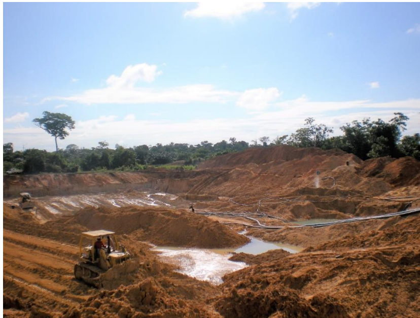
Figura 5 Desmonte de minério secundário com a utilização de mangueiras com jatos de água no norte de Mato Grosso. Fonte: A autora
