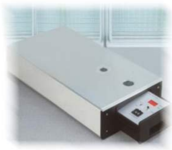
Figura 5: Aparelho utilizado para o teste de hiperalgesia térmica- Hargreaves. A figura ilustra o local aonde o animal permanece enquanto o estímulo térmico é emitido através da superfície de vidro (circunferência localizada no centro do aparelho). ( www.ugobasile.com ).
