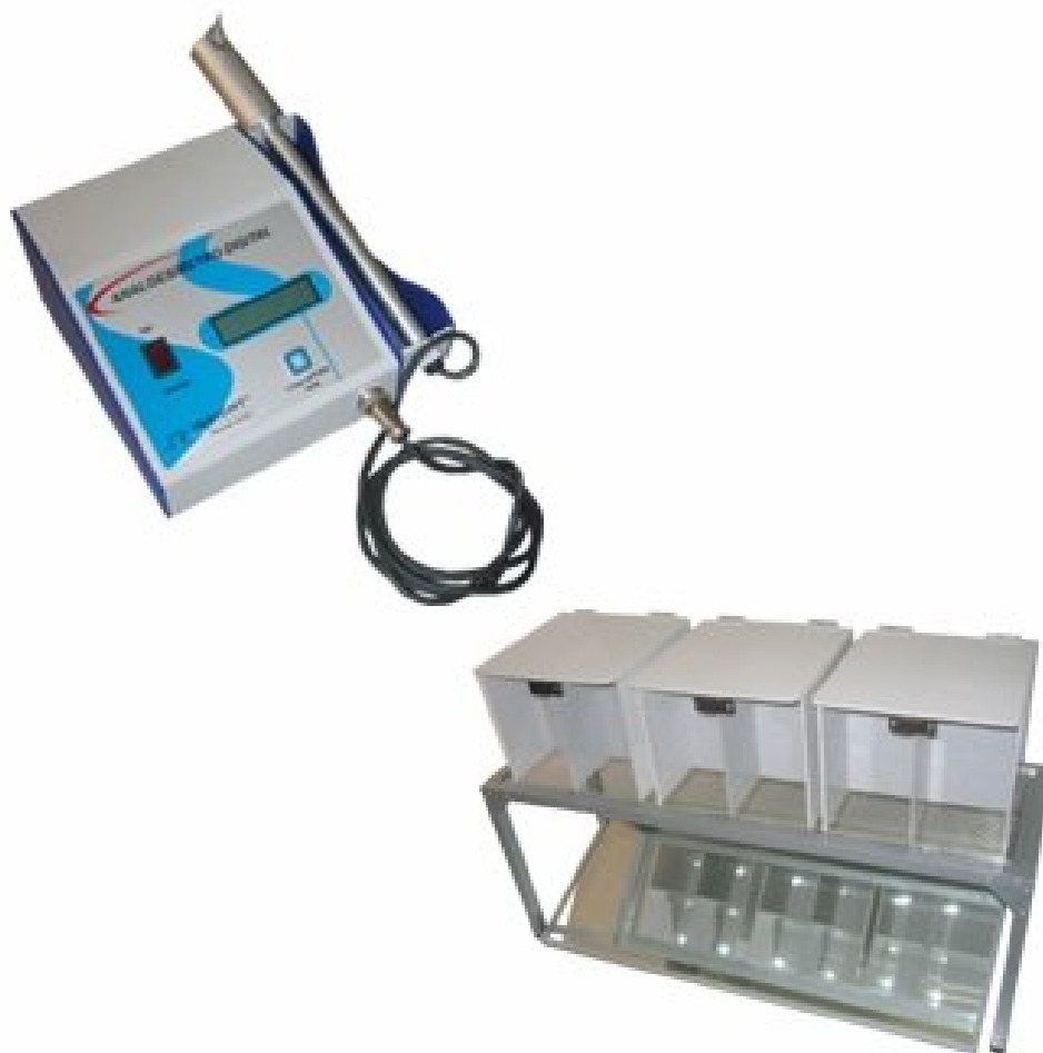
Figura 4: Aparelho utilizado para o teste de hiperalgesia mecânica-von Frey. A figura ilustra o box de acrílico amparado na superfície gradeada e o espelho que auxilia a inserção do transdutor de força através da grade. ( www.insightltda.com.br ).
