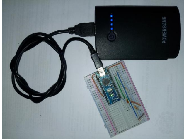
Figura 31 - Arduino conectado ao power bank . FONTE: O autor
