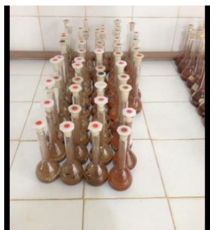
Figura 16. Determinação da Densidade de Partículas ( D_p ). Fonte: João Henrique Gaia Gomes (2015).
