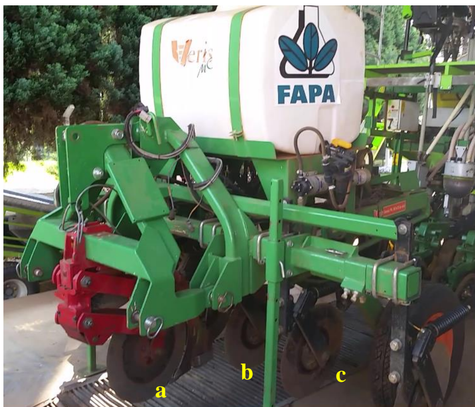
Figura 7. Equipamento modelo Veris PMC ® . Localização dos discos (a – matéria orgânica; b – condutividade elétrica e c – pH).
