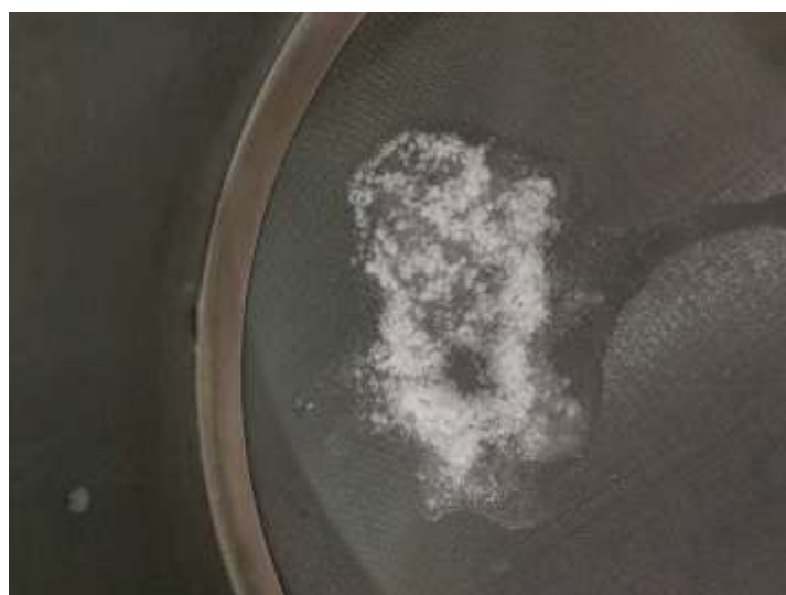
Figura 14C. Sedimentos formados em alguns tratamentos em mistura para a cultura da soja que continham os produtos Flex ® e Zapp PRO ® , testados na avaliação de 150 \text{ L ha}^{-1} , no ensaio estático, na avaliação de 6 horas. Seropédica - RJ/2021.
