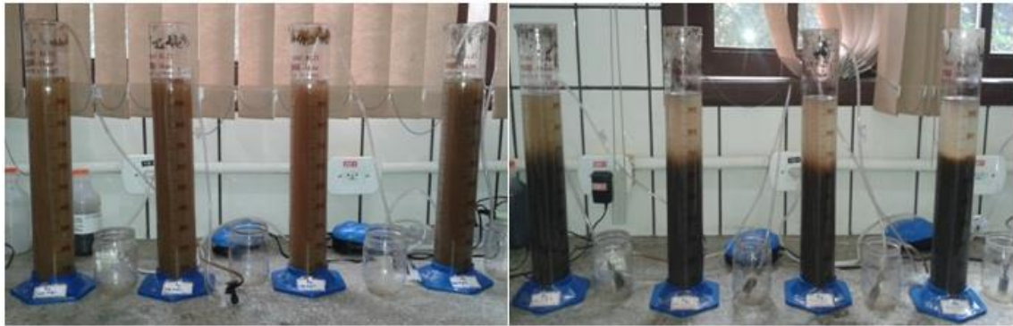
Figura 10: Reatores 1, 2, 3 e 4, respectivamente. (A) Etapa de aeração, (B) Etapa de sedimentação
