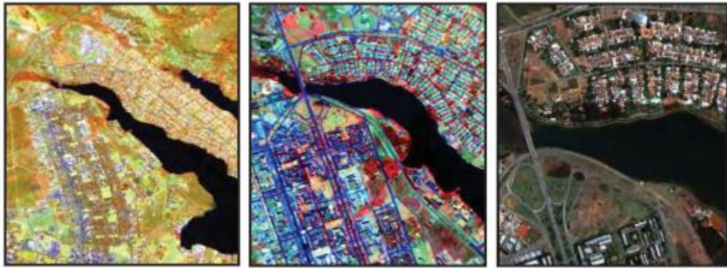
Figura 3. Da esquerda para a direita, imagens dos satélites, Landsat com resolução espacial de 30m, Spot com 10 m e Ikonos com 1 m, de uma porção do lago Paranoá em Brasília, DF. Fonte: Meneses e Almeida (2012).
