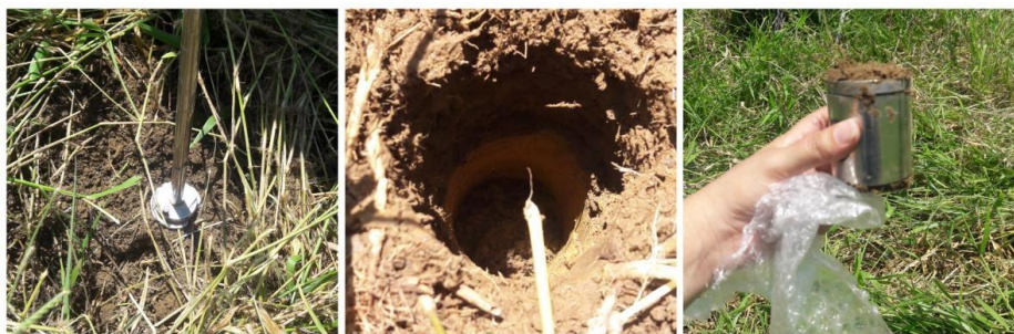
Figura 6: Coleta de amostras indeformadas de solo na área experimental para realização das análises físico-hídricas do solo. Fonte: Martins (2019).
