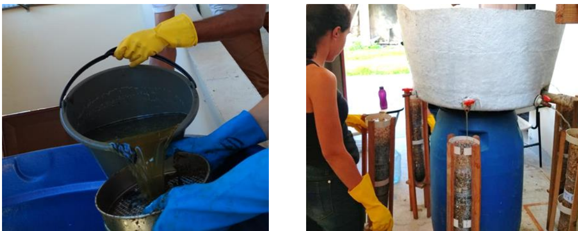
Figura 12. Remoção de sólidos grosseiros com auxílio de uma peneira de 4,0 mm de abertura de malha (A) e regime contínuo de escoamento para alimentação das colunas (B).
