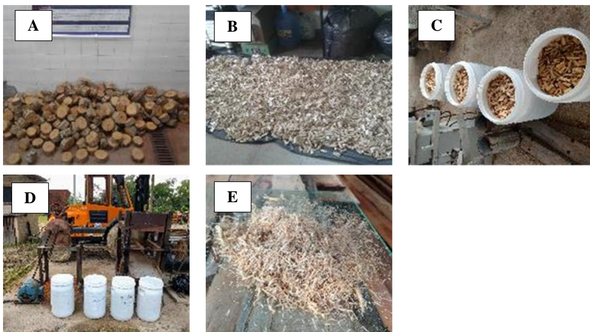
Figura 8. Detalhamento do processamento da madeira de Corymbia citriodora para obtenção das partículas de madeira. Madeira cortada em discos (A), corte em cavacos (B), hidratação do material (C), processamento no moinho (D) e amostra do resultado das partículas processadas (E).
