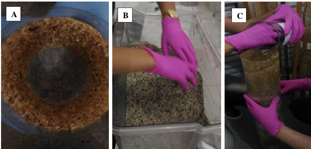
Figura 10. Vista superior da coluna de garrafas PET utilizada como suporte para o filtro orgânico (A), homogeneização do material orgânico (B) e preenchimento das colunas (C).
