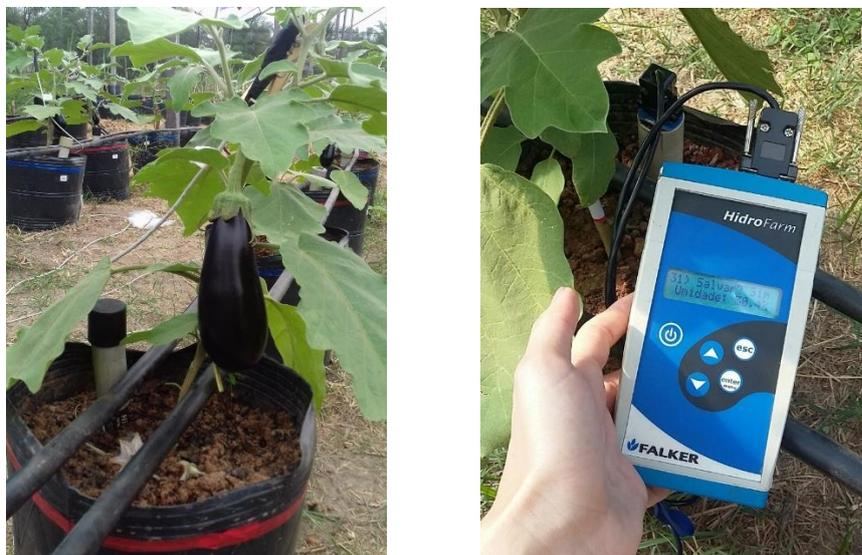
**Figura 11.** Posição do sensor de umidade do solo instalado no vaso (a). Momento da medição da umidade do solo (b).
