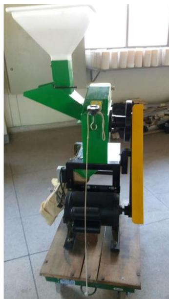
**Figura 2:** Equipamento utilizado para triturar o sabugo do milho e a serragem de madeira
