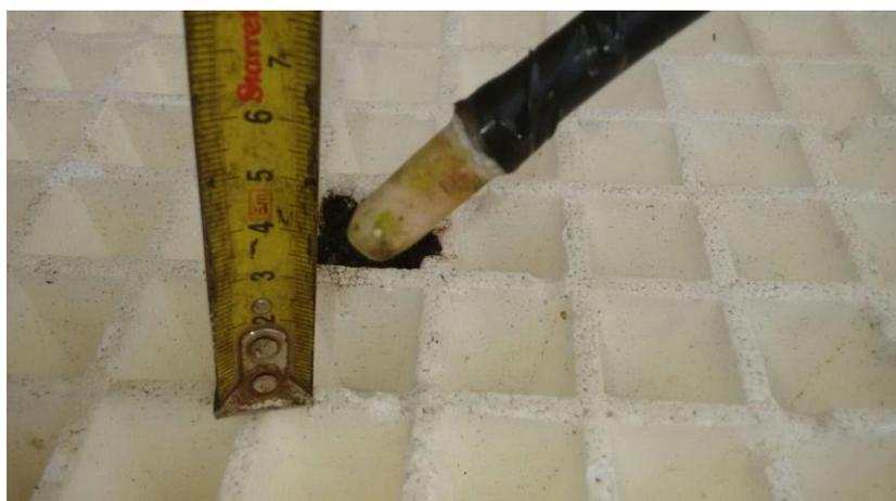
**Figura 10** – Detalhe do sensor apresentando proliferação de algas na superfície de contato com a atmosfera.
