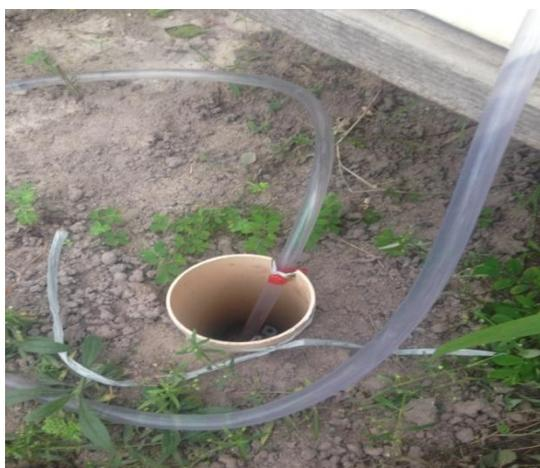
**Figura 7** - Cano de PVC de proteção do pressostato instalado no interior da casa de vegetação, tornando possível a regulagem das tensões avaliadas.
