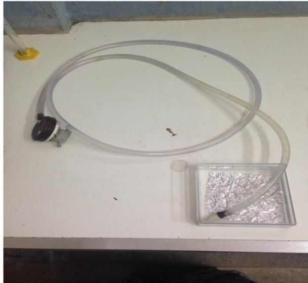
**Figura 11** - Acionador mergulhado em solução de sulfato de cobre 100 ppm, antes da instalação na casa de vegetação.
