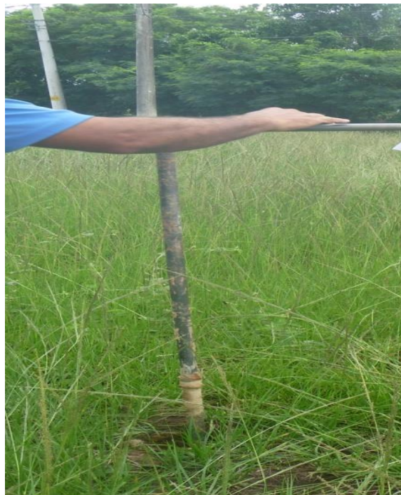
Figura 15. Perfuração com trado manual Fonte: acervo próprio (2015)
