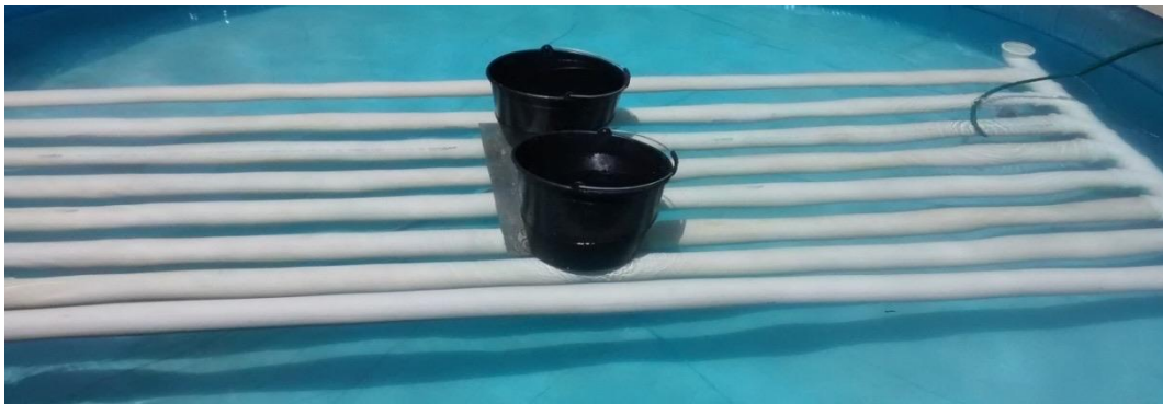
FIGURA 19: Teste de flutuabilidade
