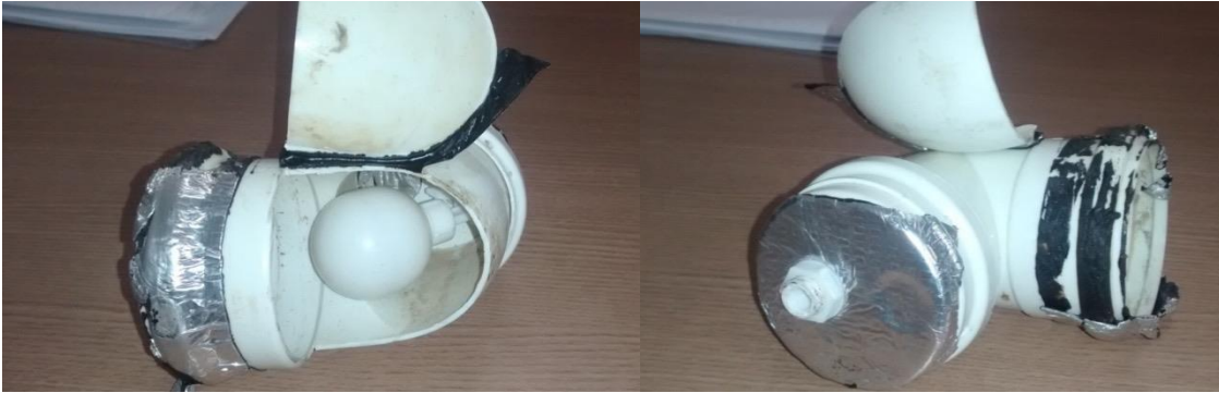
FIGURA 31: Boia de aquário para controlar a entrada de água no canteiro
