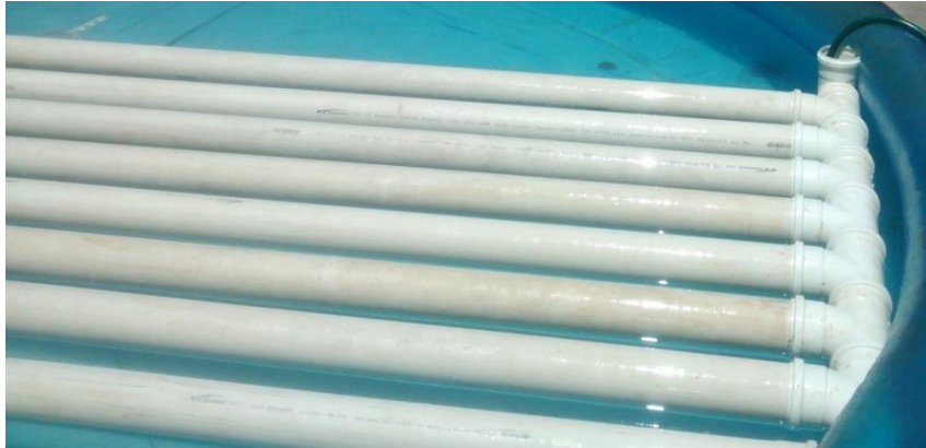
FIGURA 20: Teste de estaqueidade para verificar entradas e saídas de água
