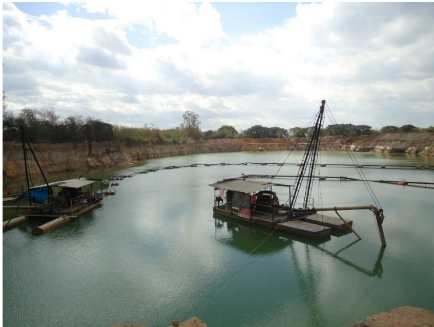
FIGURA 66: Conjunto de balsa e lança de exploração
