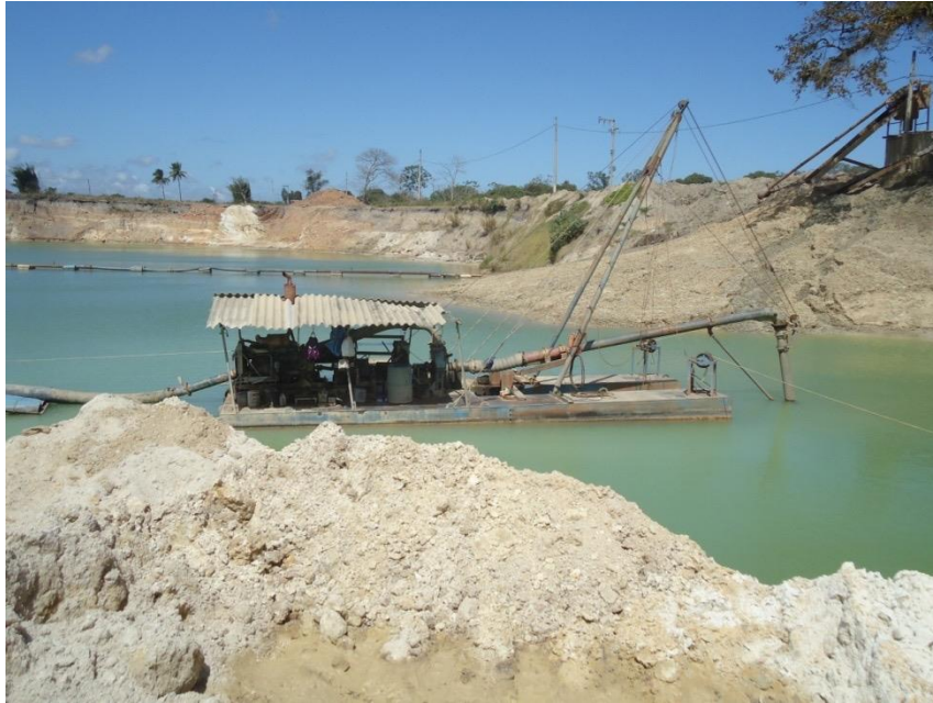
FIGURA 73: EXPLORAÇÃO COM BALSA TRANSPORTANDO A AREIA DIRETAMENTE PARA O SILO
