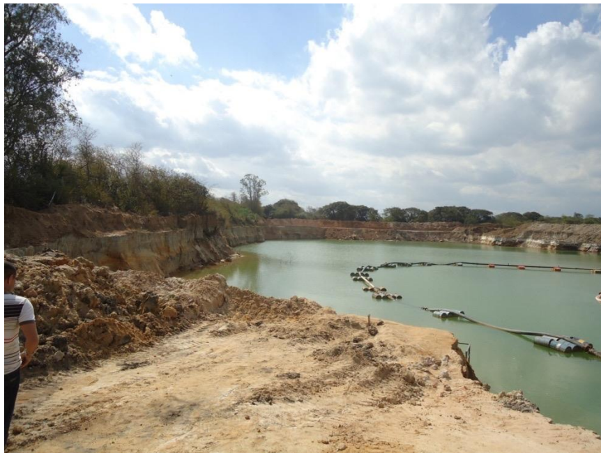
FIGURA 68: EXPLORAÇÃO SEM TALUDAMENTO
