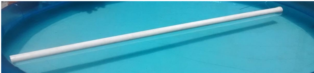
FIGURA 24: Teste de flutuabilidade
