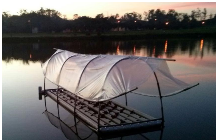
FIGURA 36: Teste no lago, cobertura com forma que permite a circulação de ar
