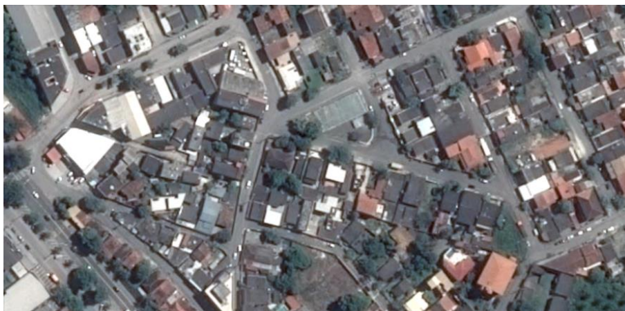
Figura 81: Imagem aérea de parte da sub-bacia do bairro Boa Esperança com alta taxa de impermeabilização do solo. Fonte: Google Maps.
