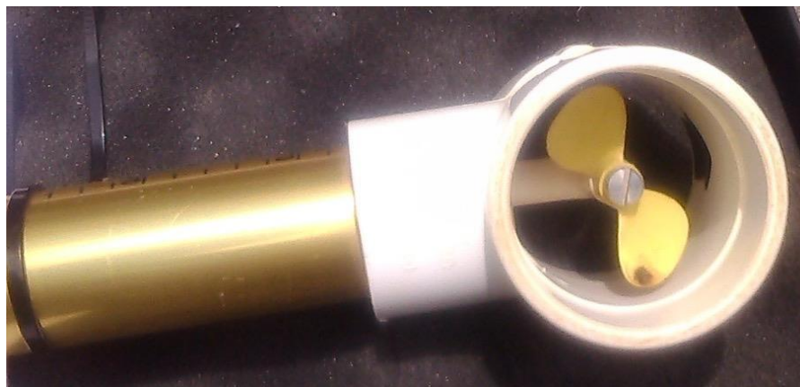
Figura 73: Detalhe da hélice utilizada na determinação da velocidade do fluxo por contagem de giros. Fonte: acervo do autor.
