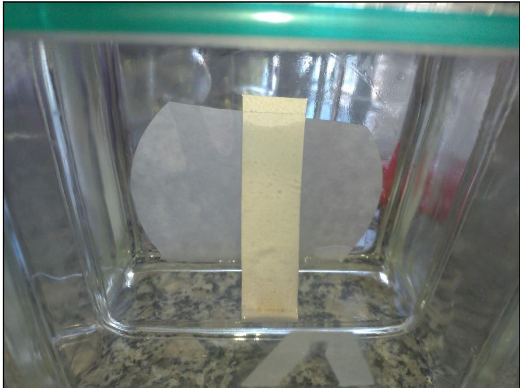
Figura 11. Eluição da fase móvel na cromatoplaca.
