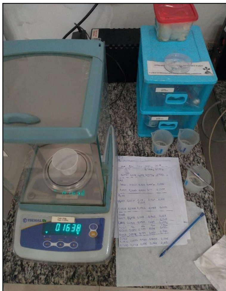
Figura 35. Método de pesagem na uniformidade de peso.
