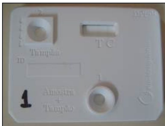
Figura 4. Plataforma plástica com dois poços por onde são conduzidas amostra e solução tampão, ocorrendo a reação do TR DPP®.
