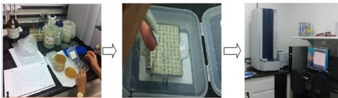
Figura 16. 1. Amostras cultivadas em ágar BHI foram transferidas para a microplaca de metal; 2. Solução da Matriz foi adicionada ao sedimento bacteriano para serem processados; 3. Microplaca de metal foi introduzida ao espectrômetro de massa MALDI, e os espectros obtidos da amostra desconhecida foram confrontados com o software do computador. (foto: acervo pessoal)
