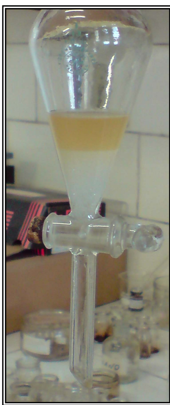
Figura 32. Funil de separação contendo amostra do extrato aquoso de Solanum lycocarpum evidenciando a formação de duas fases, após adição de clorofórmio.
