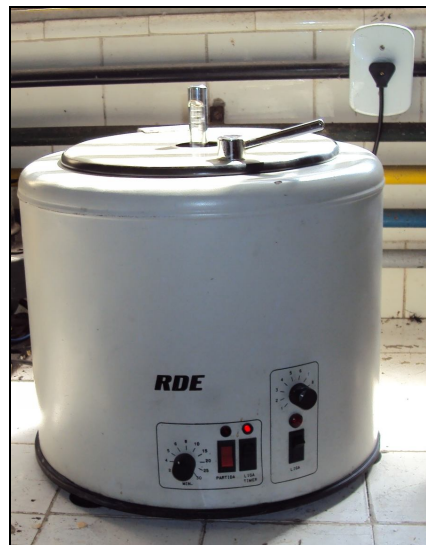
Figura 24. Centrífuga utilizada na técnica de centrífugo-flutuação com solução saturada de sacarose no laboratório de Coccídios e Coccídioses, PSA, UFRRJ.
