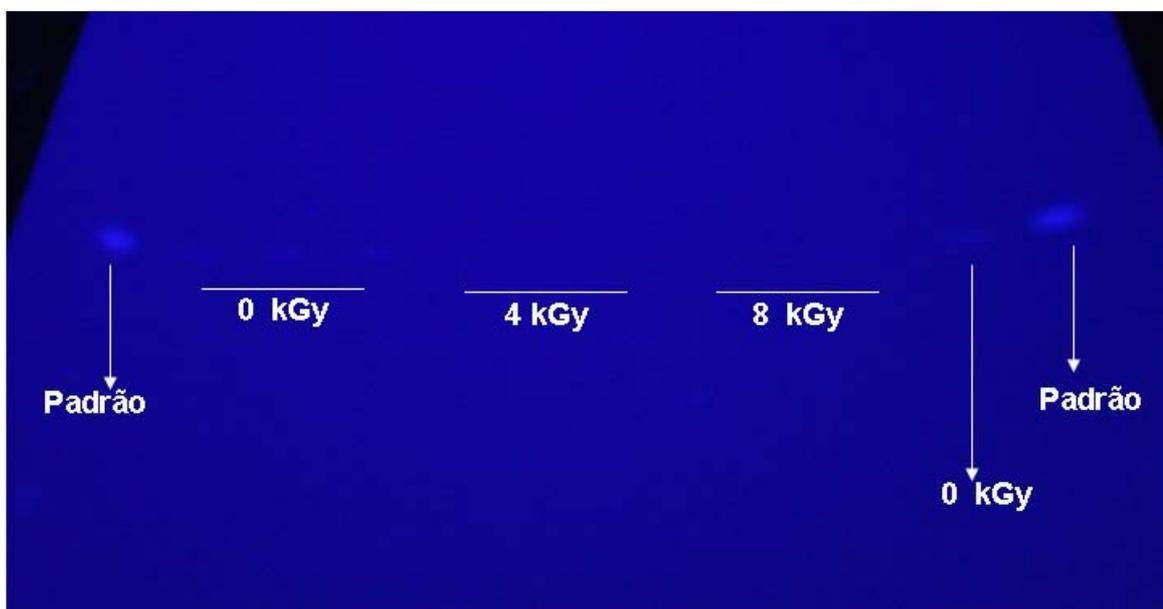
Figura 20. Cromatografia em camada delgada de AFB<sub>1</sub> na concentração de 500ppb ( $0,5 \mu\text{g ml}^{-1}$ ) submetido a 0, 4 e 8 kGy de radiação gama. Foi injetado  $15 \mu\text{l}$  das amostras, três aplicações cada, e  $5 \mu\text{l}$  do padrão de AFB<sub>1</sub> com  $18,0645 \mu\text{g ml}^{-1}$ .
