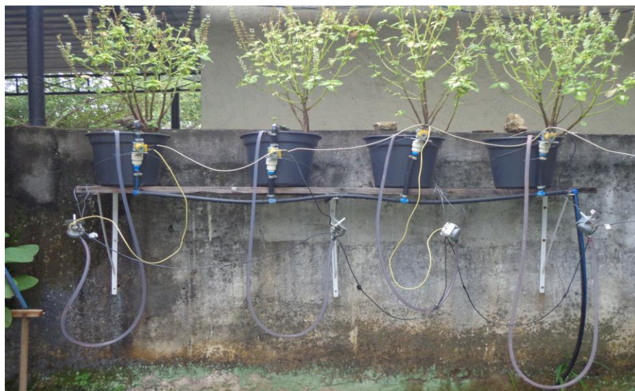
Figura 8: Ensaio implantado no Município do Rio de Janeiro, com os pressostatos posicionados a 30 cm abaixo do sensor.
