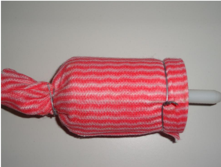
Figura 7: Sensor com revestido de tecido a fim de mitigar a perda de sensibilidade.
