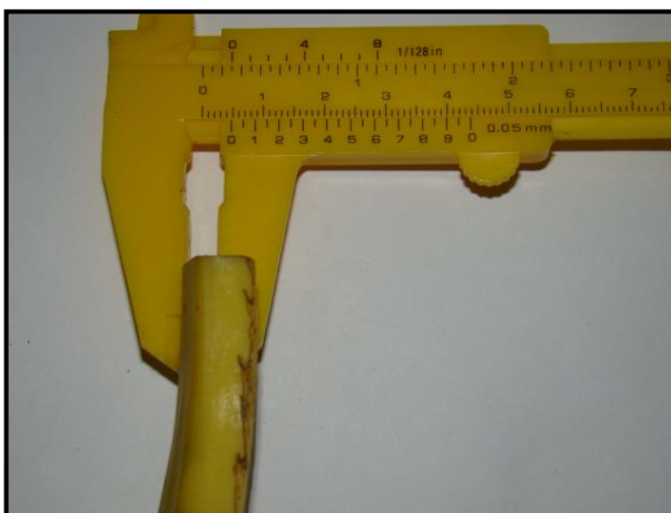
Figura 34. Determinação da espessura da casca (mm) com a utilização de paquímetro de 150 mm.
