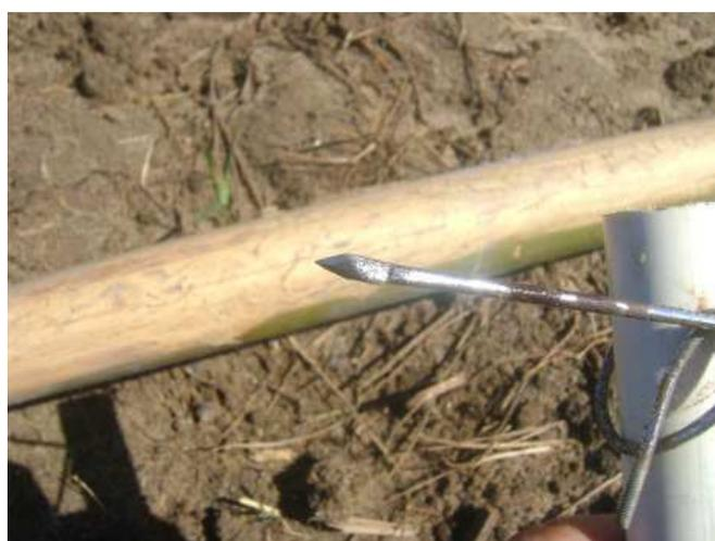
**Figura 9.** Mecanismo furador artesanal para colocação dos emissores.
