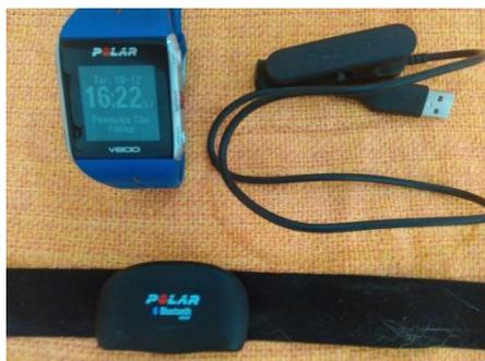
Figura 14: Frequencímetro utilizado para gravação dos dados referentes a atividade cardíaca Relógio Polar® RS800CX, faixa elástica, eletrodo e conector.
