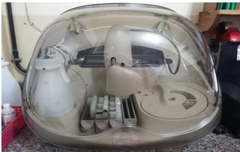
**Figura 03:** Analisador automatizado de acesso randômico para realização de dosagens bioquímicas e turbidimétricas, por leitura fotométrica
