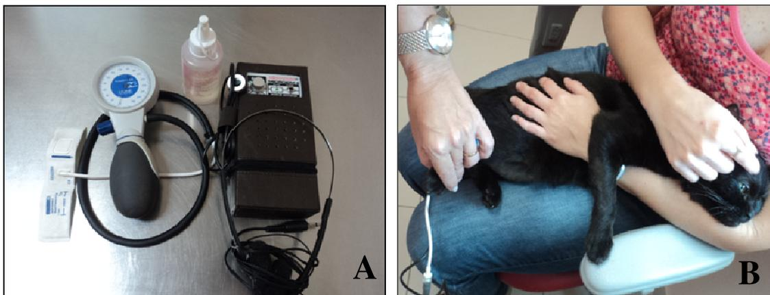
**Figura 1.** A) Material utilizado para a aferição da pressão arterial dos gatos composto por: esfigmomanômetro com manguito, gel condutor, doppler ultrassônico com transdutor e fones de ouvido. B) Posicionamento do gato 31 para a aferição da pressão arterial. Notar que o animal está posicionado confortavelmente no colo do proprietário que acaricia a sua cabeça para minimizar a influência do estresse durante o exame.
