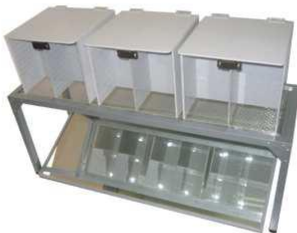
Figura 7: Aparelho utilizado para realização dos testes de hiperalgesia mecânica- Von Frey. A figura mostra o box de acrílico na superfície gradeada e o espelho que auxilia na inserção do transdutor de força pela grade ( www.insightltda.com.br )
