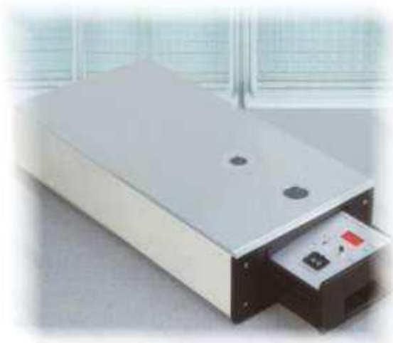
Figura 8: Aparelho utilizado para realização dos testes de hiperalgisia térmica- Hargreaves. A figura ilustra o local onde o animal permanece enquanto recebe o estímulo térmico através da superfície de vidro.
