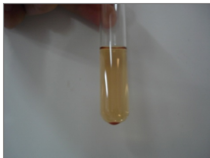
Figura 2 – Frasco com líquido de Drabkin mostrando o acúmulo de núcleo ao fundo após centrifugação
