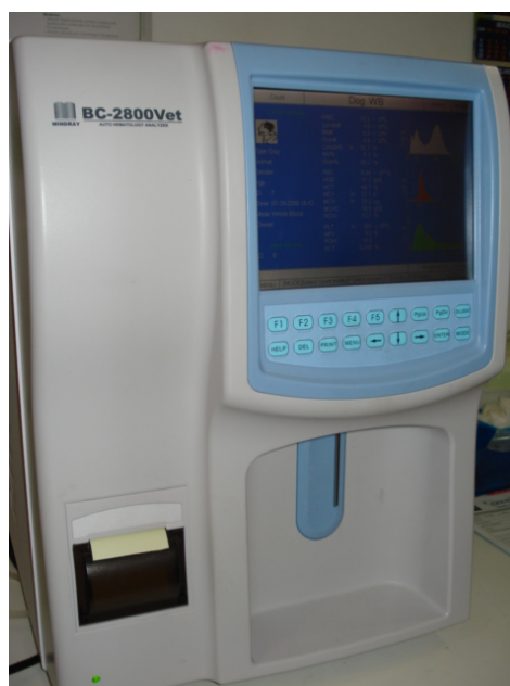
Figura 5. Vet auto analisador hematológico
