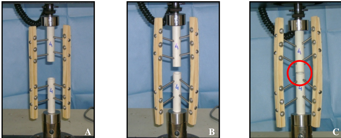
Figura 20 – Seqüência do teste de compressão axial do corpo de prova número quatro pertencente ao grupo A (corpos de prova com aparelhos de fixação esquelética externa confeccionados com barras de conexão de madeira e oito pinos de inserção - quatro por fragmento/ dois por barra estabilizadora em cada fragmento). A) Início do teste, B) Angulação dos pinos de inserção, C) Contato dos fragmentos, determinando o término do ensaio.
