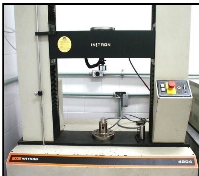
Figura 15 – Máquina de teste mecânico Instron modelo 4204, utilizada para promover compressão axial durante os ensaios.
