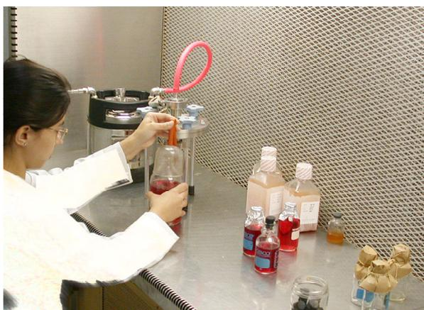
**Figura 1.** Filtragem do MEM em membrana Millipore, usando pressão positiva, em capela de fluxo laminar horizontal.
