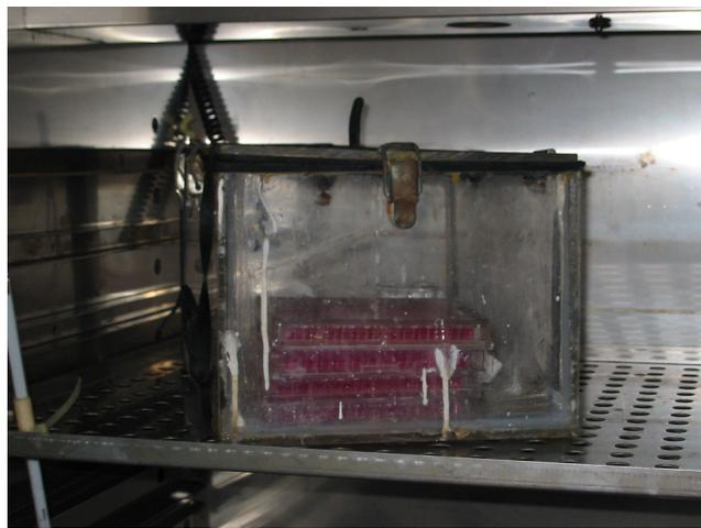
**Figura 6.** Camara de CO<sub>2</sub> contendo as microplacas em teste, colocadas na estufa.
