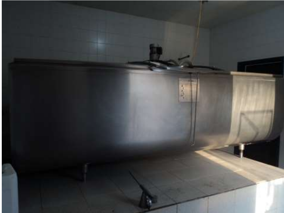
Figura 3: Tanque de resfriamento de leite de aço inoxidável, capacidade 10.000 litros. Propriedade no sul do estado do Rio de Janeiro. Rio de Janeiro. 2016.
