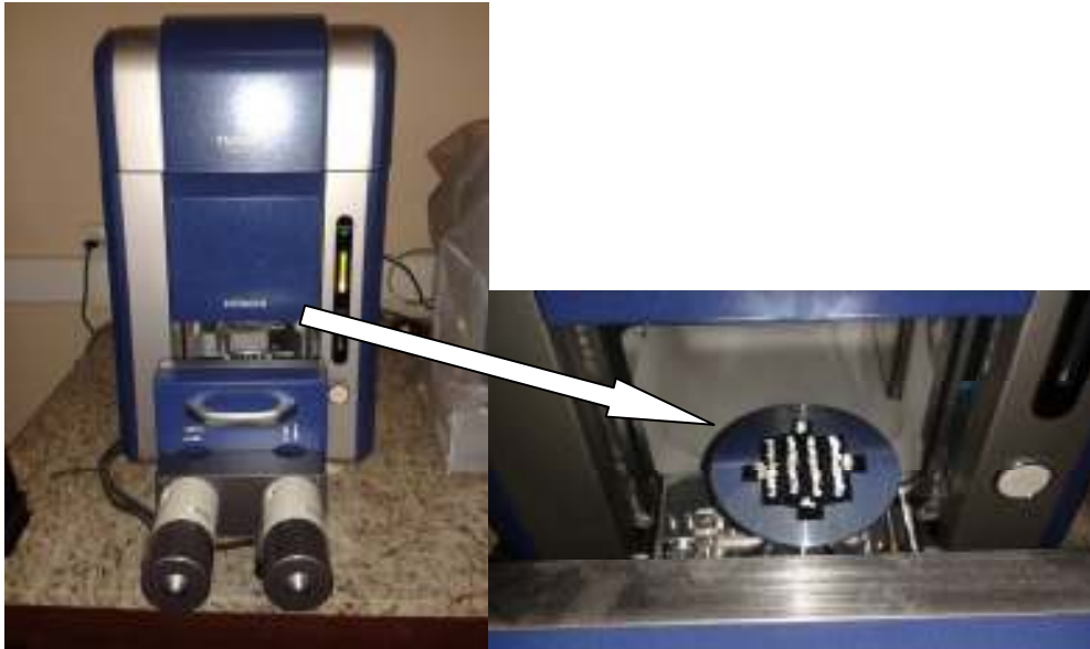
Figura 15 - MEV e Stub com fragmentos da casca sendo acoplado ao MEV
