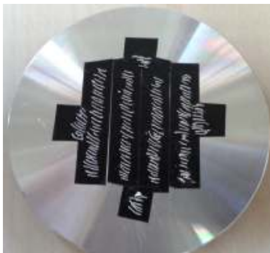
Figura 14 - Fragmentos da casca de ovos de codorna montados no stub de alumínio
