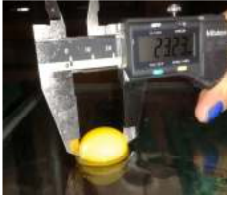
Figura 12 - Determinação da largura da gema com paquímetro digital
