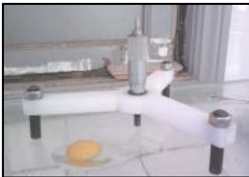
Figura 11 - Determinação da altura do albúmen denso com micrômetro tripé adaptado.
