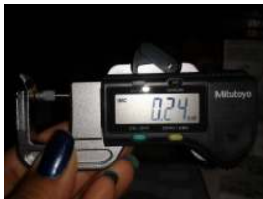
Figura 13 - Determinação da espessura da casca com auxílio do micrômetro digital de pressão Mytutoyo.
