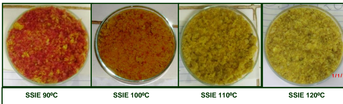
Figura 9. Soja Semi Integral Extrusada (SSIE), análise ureáse qualitativa através do teste rápido visual
