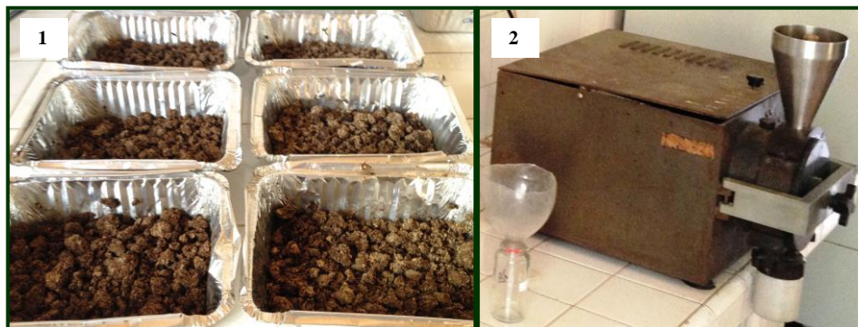
Figura 6. 1- sub amostras de 400 gramas acondicionadas em recipiente de alumínio. 2- moinhos tipo faca utilizado no processo de moagem das amostras após a pré-secagem
