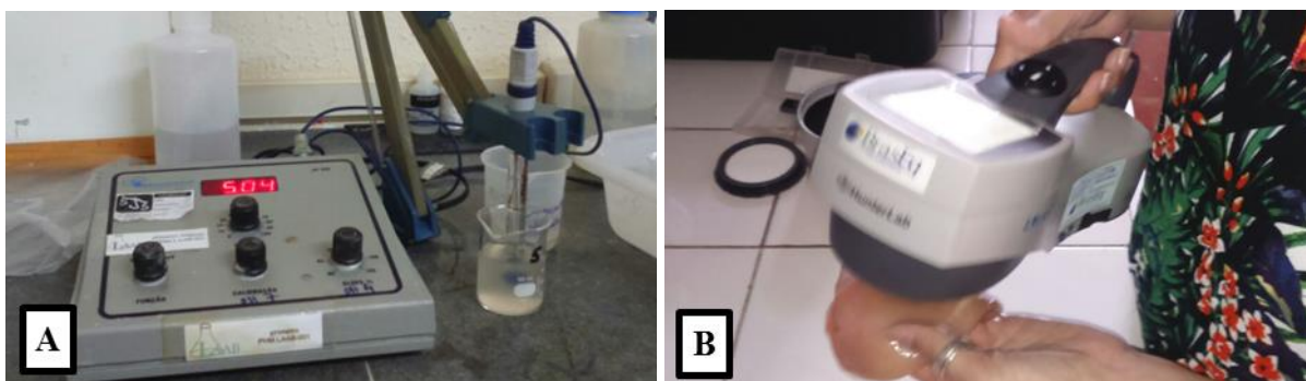
Figura 8. A) Medidor de pH (Analyser 300M). B) Espectrofotômetro portátil (Hunterlab – MiniScan EZ).
