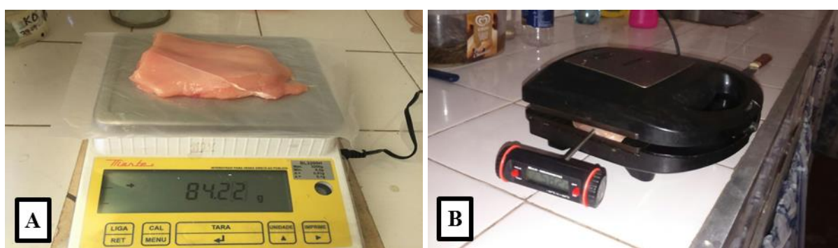
Figura 6. A) Pesagem da amostra do músculo do peito ( pectoralis major ). B) Chapa elétrica (Grill max inox – Mallory) e termômetro digital para carnes (Multi-thermometer).
