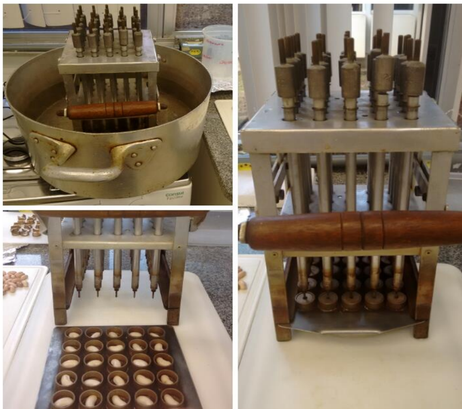
Figura 6. Penetrômetro de Burr utilizado para determinar o tempo de cozimento.
