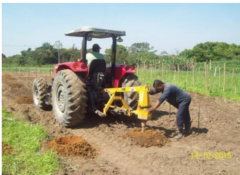
Figura 5 – Perfuração das covas para construção da espaldeira vertical.
