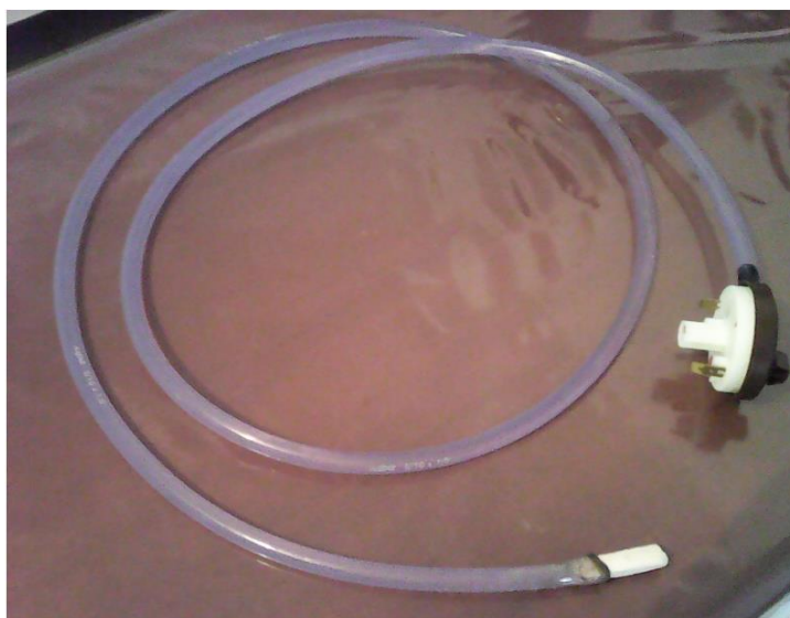
Figura 7: Detalhe da cápsula porosa e do pressostato responsáveis pelo acionamento do sistema de irrigação.
