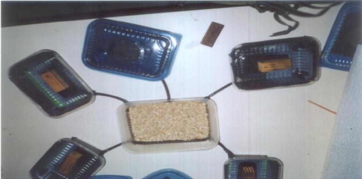
**Anexo II.** Esquema experimental com recipientes periféricos contendo as diferentes essências florestais, destacando a presença de vermiculita no recipiente central.
