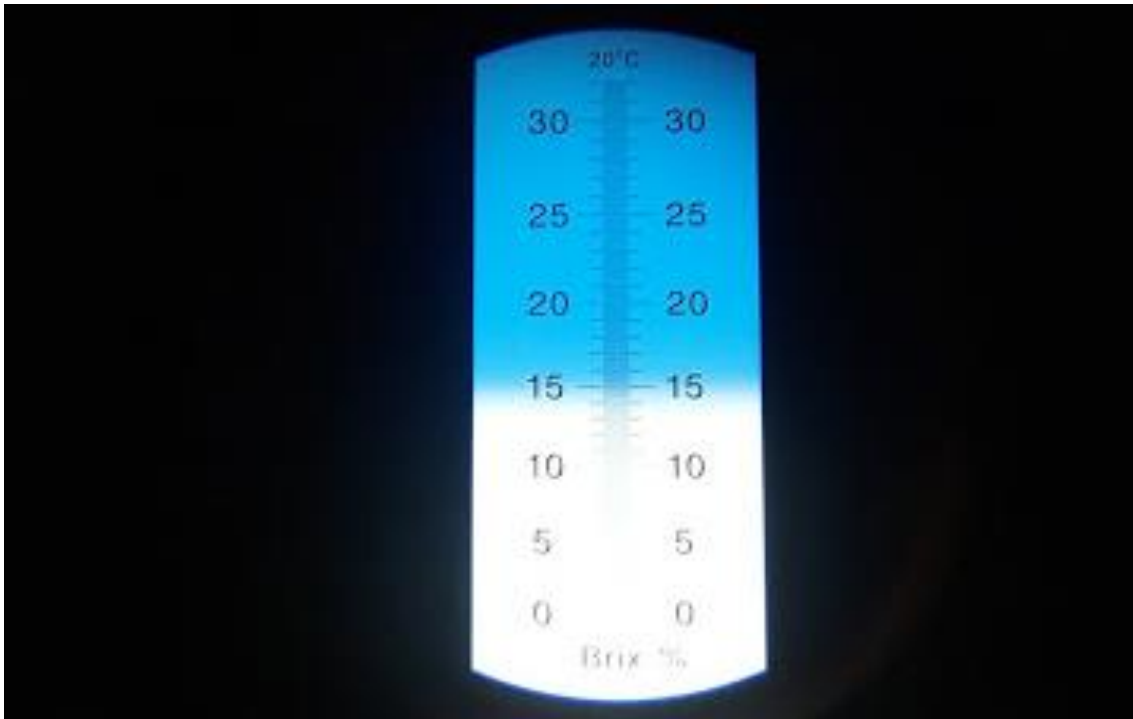
Figura 15 - Determinação de sólidos solúveis em refratômetro
