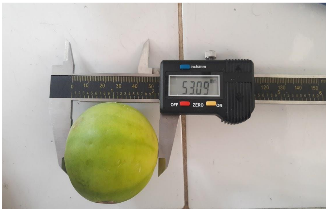
Figura 12 - Uso de paquímetro digital para determinações métricas
