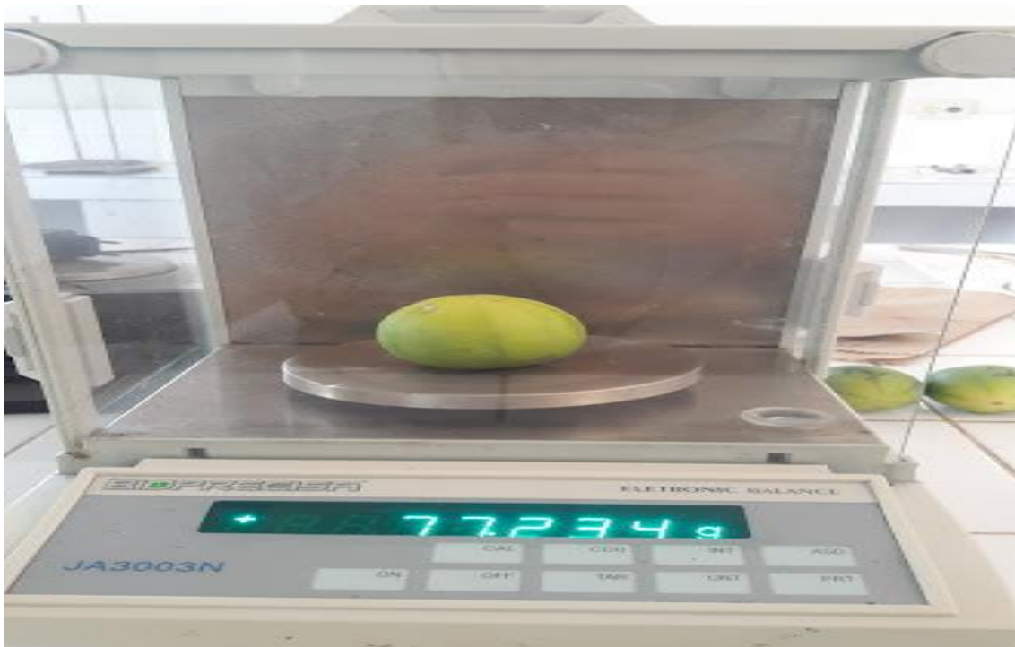
Figura 13 - Pesagem dos frutos em balança analítica
